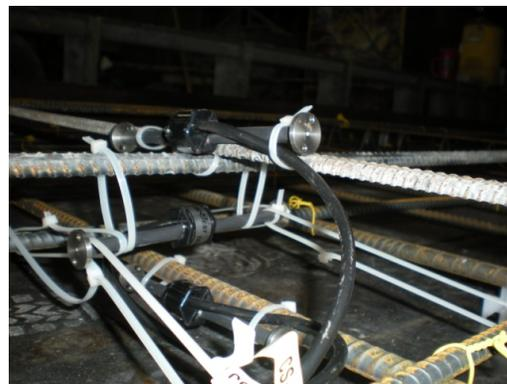
b.) HS-SCC Mild Steel VWSG Arrangement
